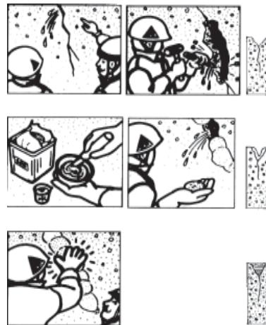
Đục bê tông hoặc đá hình chữ "V" xung quanh nơi rỉ nước. Làm sạch những mảng vữa vỡ, tạp chất và làm sạch bề mặt bằng nước trước khi thi công Sika® Plug CN.
